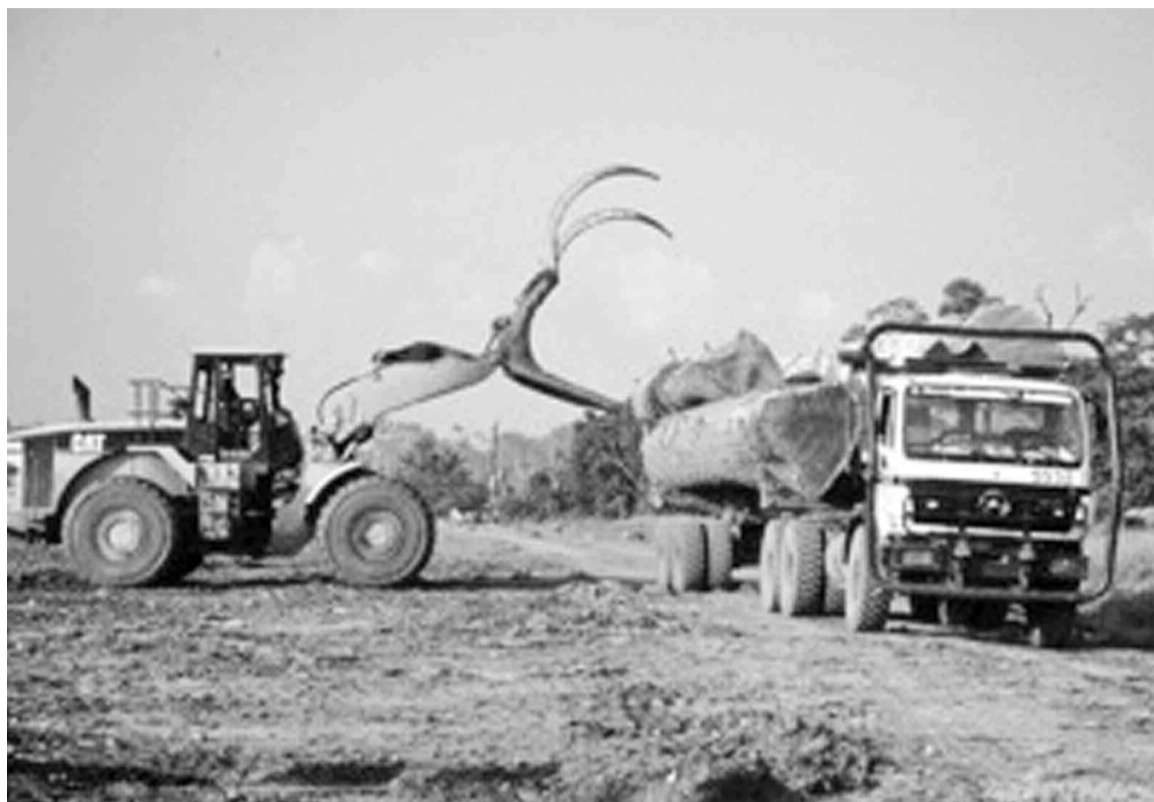
chargement des grumes sur une remorque
